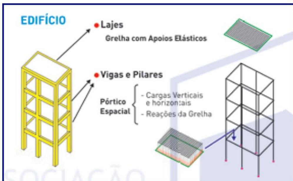
No modelo de grelha para os pavimentos, as lajes foram integralmente consideradas, junto com as vigas e os apoios formados pelos pilares, para a análise das deformações, obtenção dos carregamentos verticais que atuarão no pórtico espacial e dimensionamento das armaduras das lajes.
