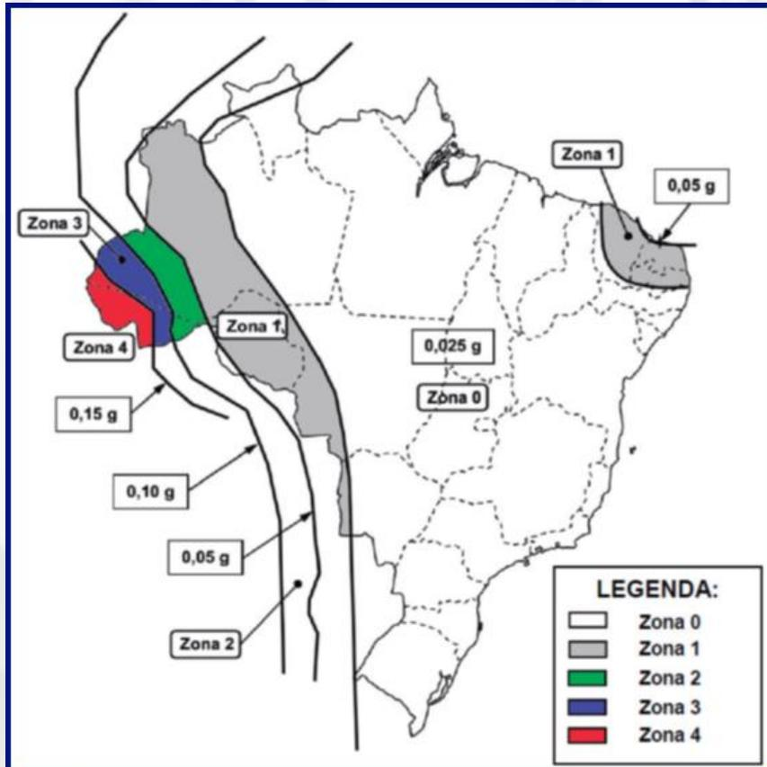
Para as estruturas localizadas na zona sísmica "0", nenhum requisito de resistência sísmica é exigido, conforme indicado na ABNT NBR 15421:2006
