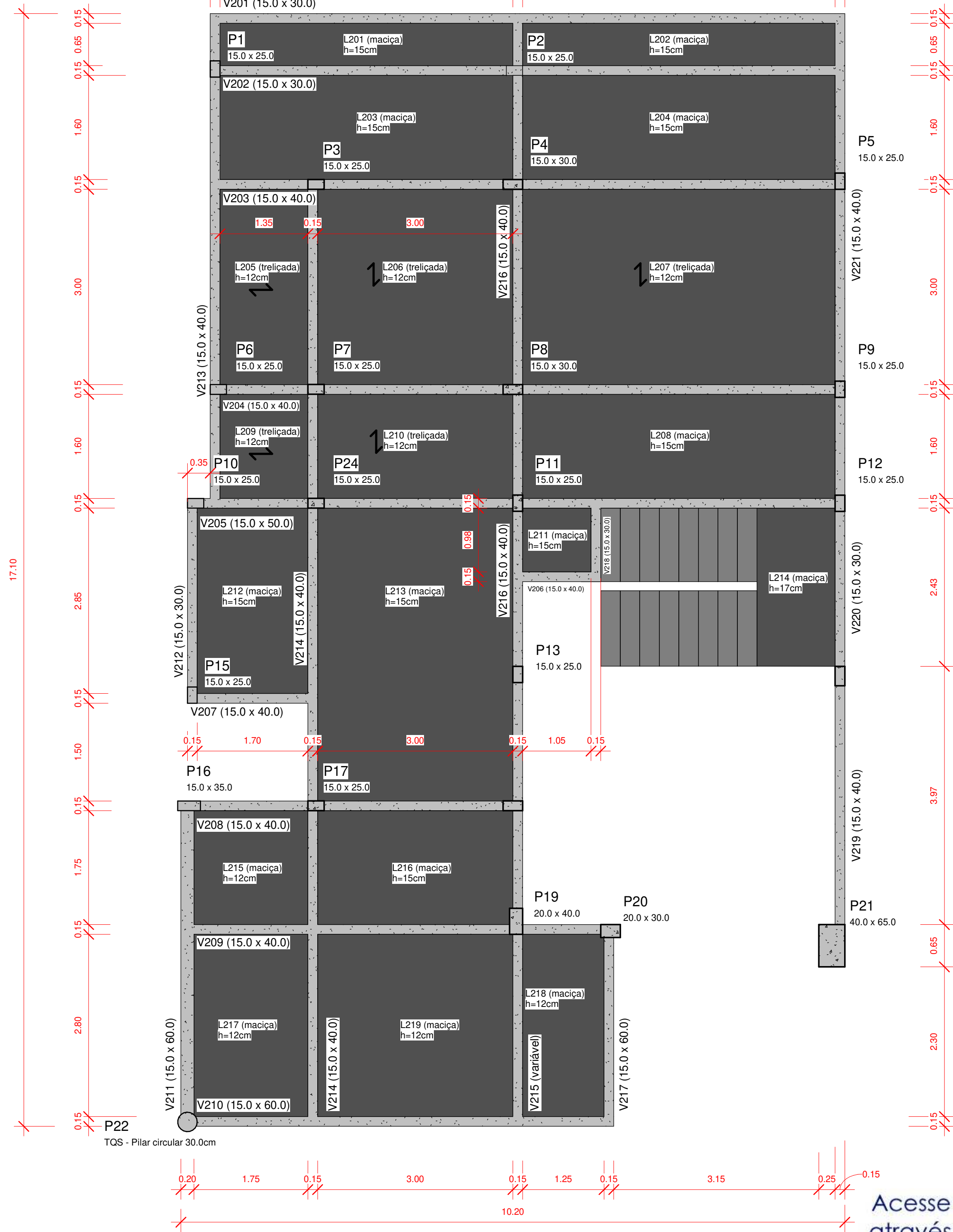
PLANTA DE FORMA - 1º PAVIMENTO
