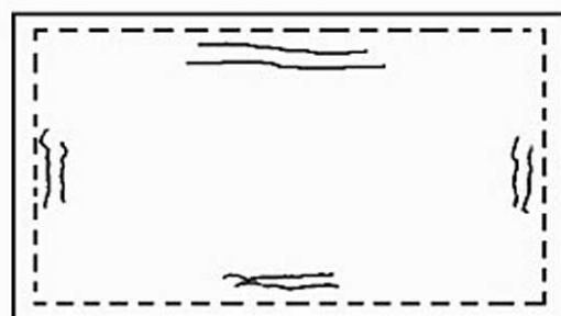
Figura 1.29 - Fissuração de flexão, devida à insuficiência de armadura para os momentos negativos. As fissuras surgem na face superior.
