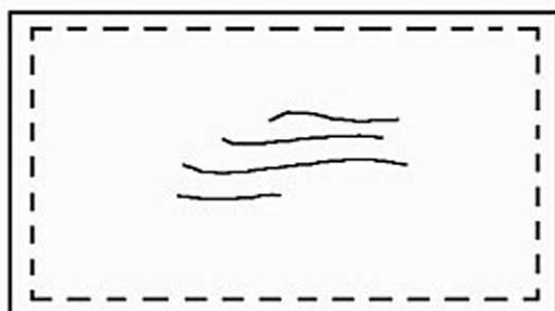
Figura 1.30 - Fissuração por esmagamento do concreto, devido à reduzida espessura da laje. As fissuras surgem na face superior, por deficiência diante dos momentos positivos.
