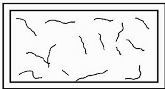
Figura 1.41 - Fissuras de retração em lajes
