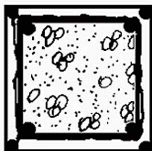
Figura 3.57- Colocação das novas armaduras no pilar
